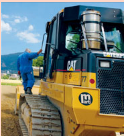
Die leistungsstarken Baumaschinen sind mit Abgasreinigungsanlagen nach neuestem Stand der Technik ausgerüstet.
